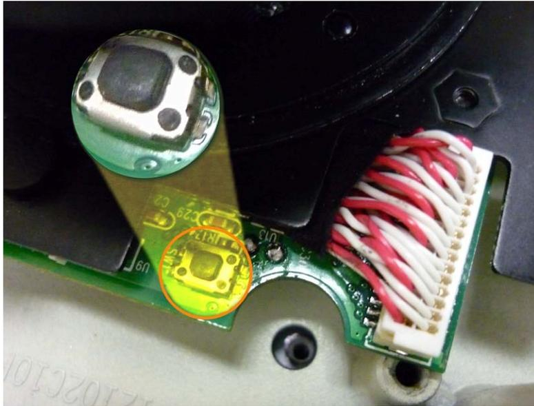
カメラに電源を再接続し、システムの起動中はボタンを放してはいけません。カメラの起動には約 30 秒かかります。
